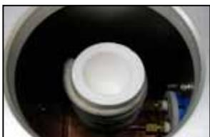
在电磁圈中直接插入45-P硅石坩埚。
