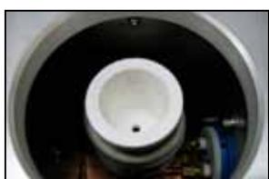
1) 在加热电磁圈中插入PC坩埚外罩。
