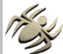
切抜き加工 蜘蛛 真鍮/厚み1.0mm/サイズ 高さ12mm/3分23秒 50W
