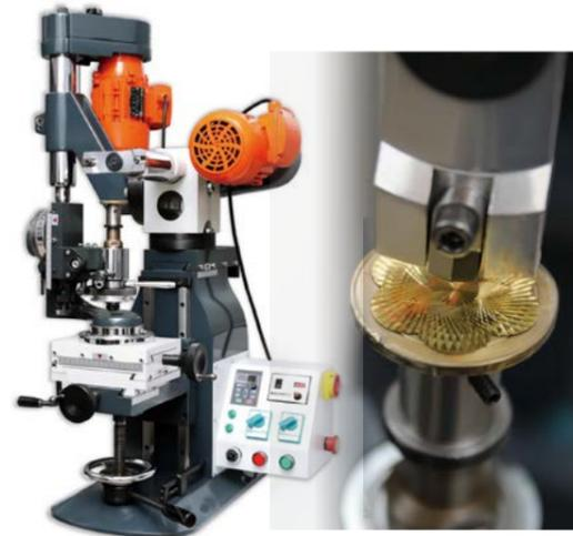
Bulunmazダブルヘッドファセットマシンは、水平ヘッドと垂直ヘッドを備えたシンプルで様々な確度でダイヤモンドカットが施せる、低コストの機械式ダイヤモンドカットマシンです。リング外側は勿論、バングルやペンダント、イヤリングなどのプレートにもこれ1台でカットを施せます。また、ジュエリー用外側用旋盤はリングの外側の鏡面出しリングの凹凸を作り表面にテクスチャーを加える事が出来ます。鈴峯ブース内にてデモンストレーションを開催致します!!是非ご来場下さい!!
